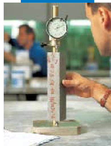
Détermination de l'expansion selon UNI 8147/80
