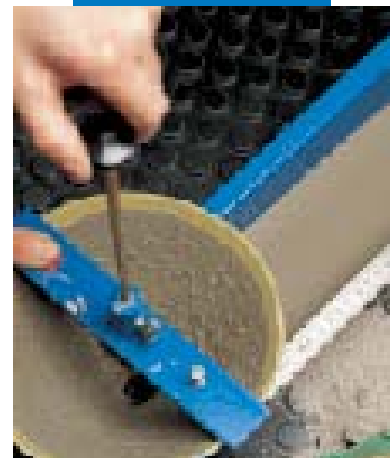
Essai d'étalement dans une goulotte selon UNI 8147/80
