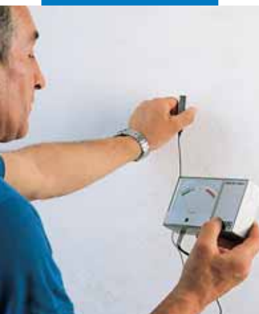
Contrôle de l'humidité du plâtre
